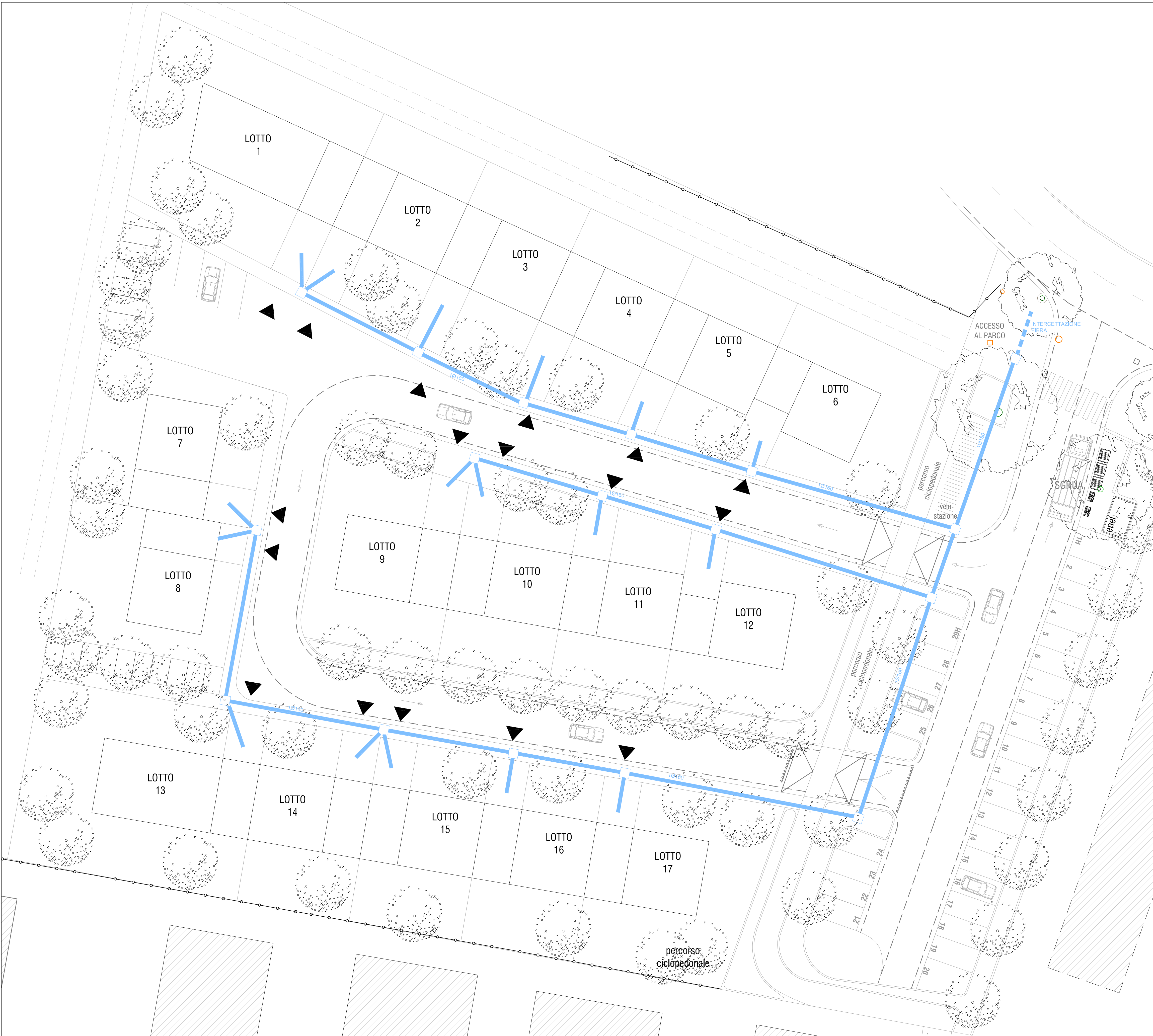
PLANIMETRIA OPERE EDILI RETE CABLAGGIO FIBRA - SCALA 1:200
